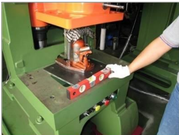
圖6)利用水平尺檢視設備水平。
