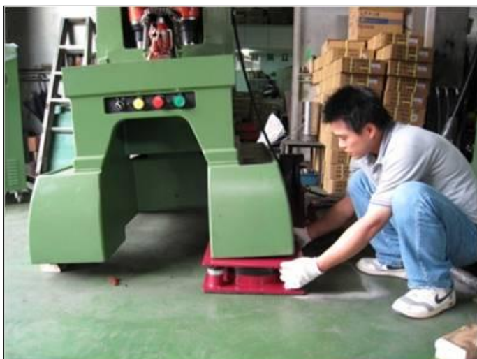
圖4)將避震器置入安裝處，並以螺栓固定之。
