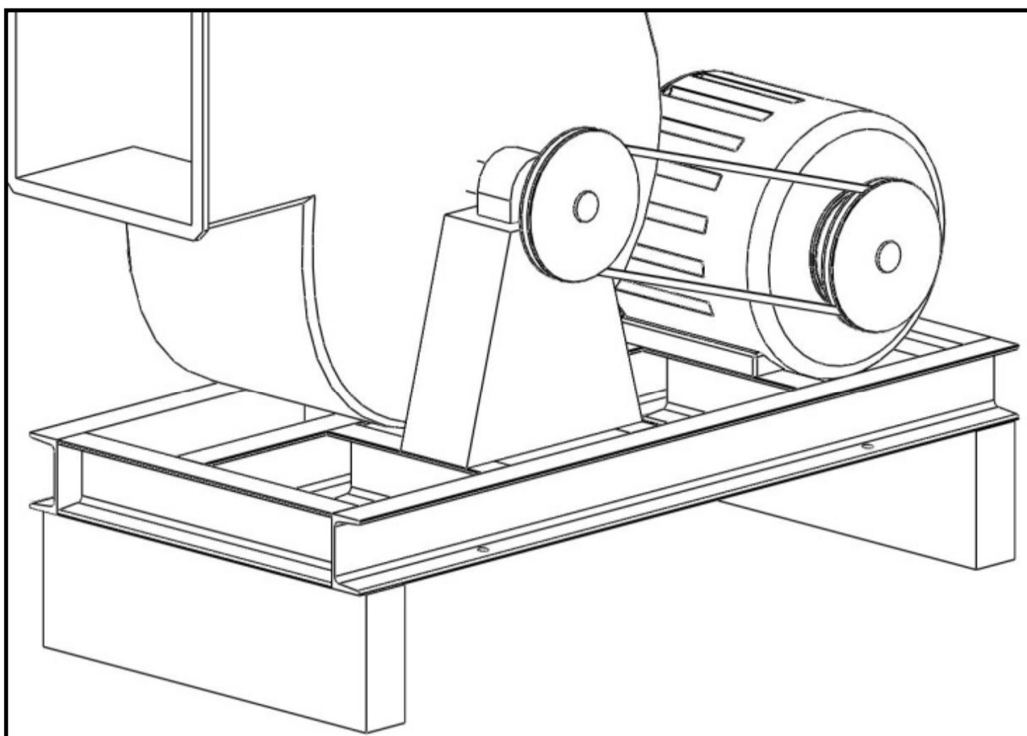
圖1)安裝設備時可先放置與避震器相同高度之臨時木台。
