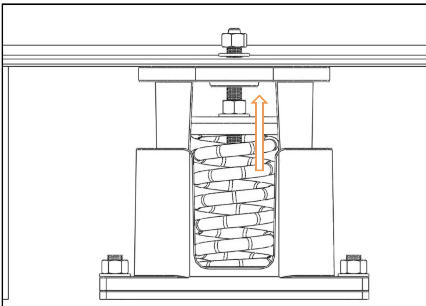
圖4)調整下部螺帽組使螺栓上升至能與設備連結，再將固定螺帽略為鎖緊。
