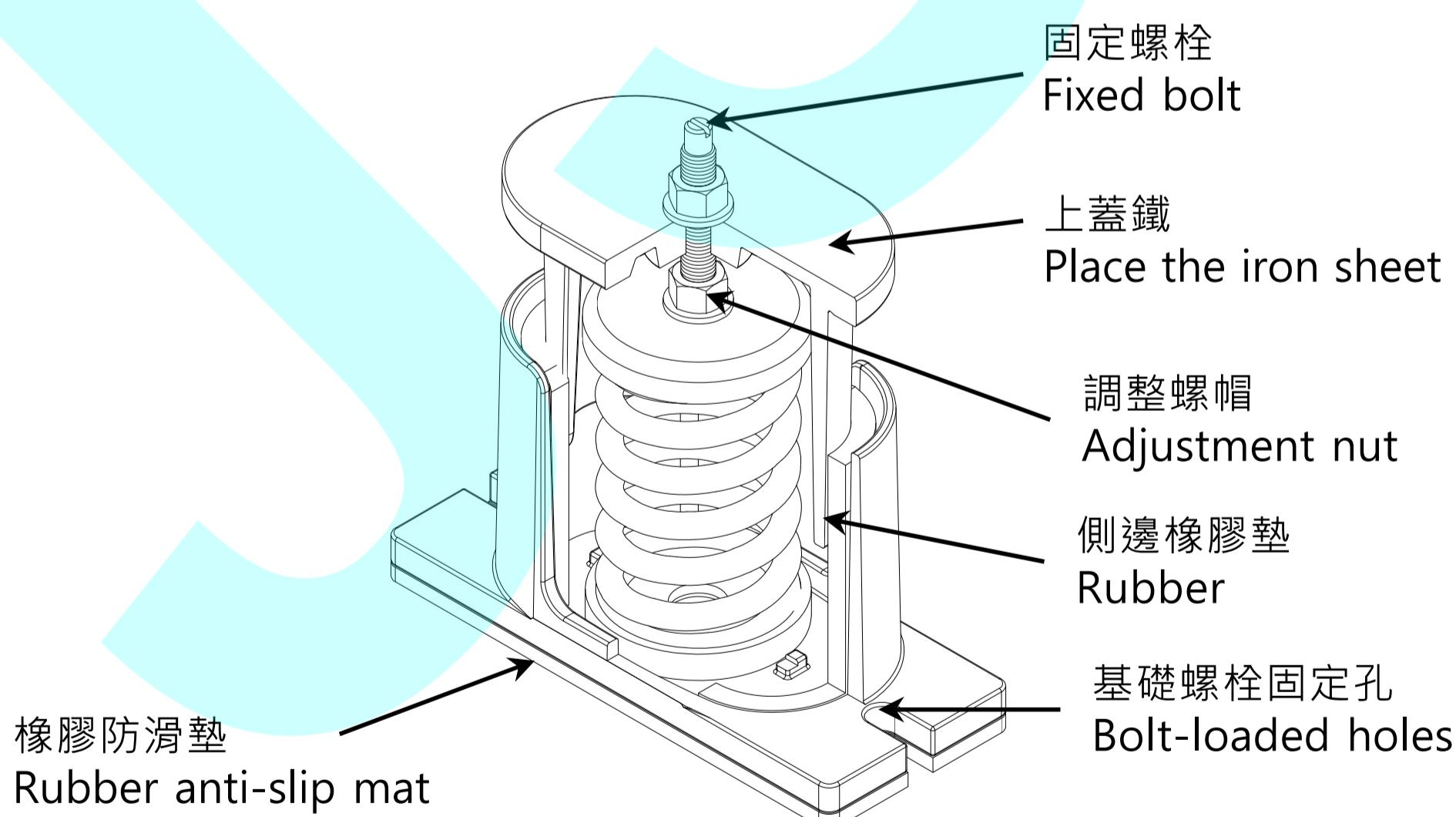
※保養點檢項目：每月觀察CS固定螺栓保持鎖固、保持避震器安裝狀態&彈簧下壓撓度正常。
